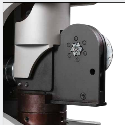
unità di crimpatura con autoregolazione, 6 superfici profilate di crimpatura, cod. art. 636 086 3
