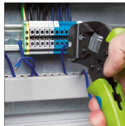
Cod. art. 610 088 3, inserimento frontale possibile fino a max. 16 mm 2 – utile in caso di estremità dei conduttori corte
