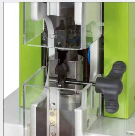
Macchina crimpatrice CM 25-2 per la lavorazione di connettori schermati
