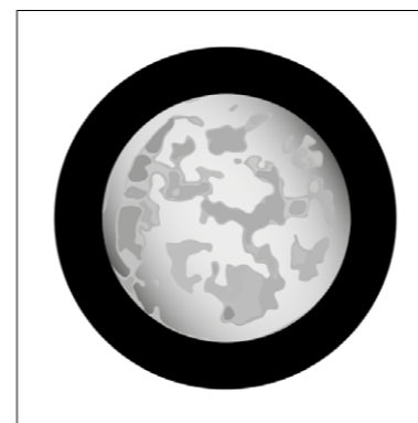
Cavo POF, tagliato con un utensile comune - una lucidatura impegnativa è necessaria
