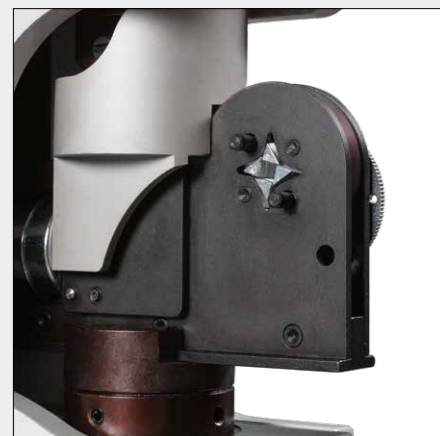
unità di crimpatura con autoregolazione, 4 superfici profilate di crimpatura, cod. art. 636 084 3
