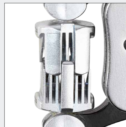
Ganasce a guida automatica
