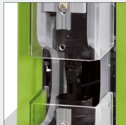
Modello CM 25-1 - Macchina crimpatrice per un utilizzo universale con dispositivo di protezione
