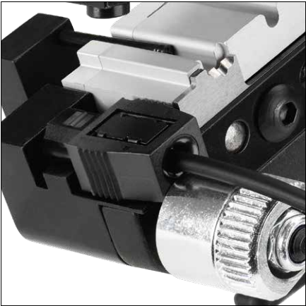
Compression du connecteur avec le câble préparé dans un seul outil
