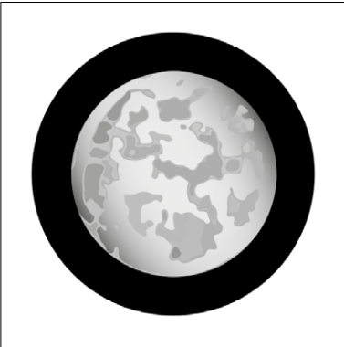
Câble POF, coupé avec des outils classiques - un polissage fastidieux est nécessaire
