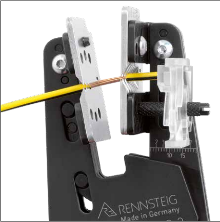
Dénudage par couteaux de forme
