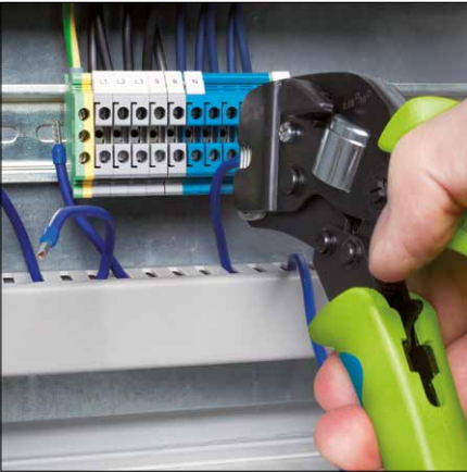
Réf. art. 610 087 3 Insertion frontale jusqu'à max. 16 mm² – avantageuse pour les extrémités de conducteurs courtes
