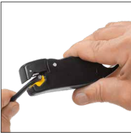
Insertion de câbles coaxiaux
