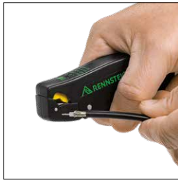
Dénudage de 3 couches en une seule opération
