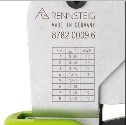
Position du selector aisément consultable sur la pince
