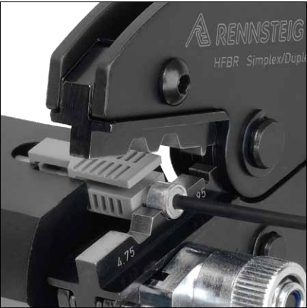
positionnement des connecteurs le plus précis possible grâce à un triple positionneur spécial et à une aide au blocage
