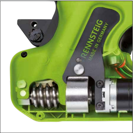
Peu de maintenance nécessaire, entraînement électromécanique
