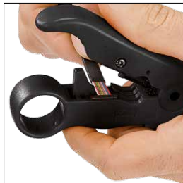
Dénudage de câbles plats
