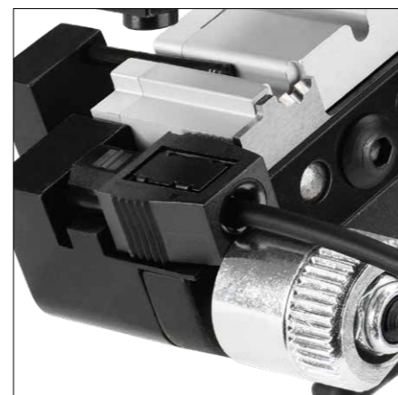
Verpressen des Steckers mit dem vorbereiteten Kabel in einem Werkzeug
