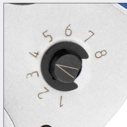
Selectorposition beidseitig an der Zange ablesbar
