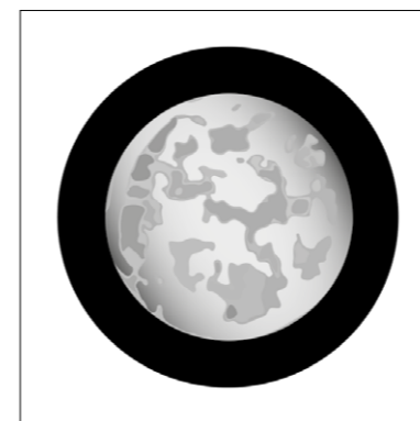
POF-Kabel, geschnitten mit herkömmlichem Werkzeug – aufwendiges Polieren notwendig
