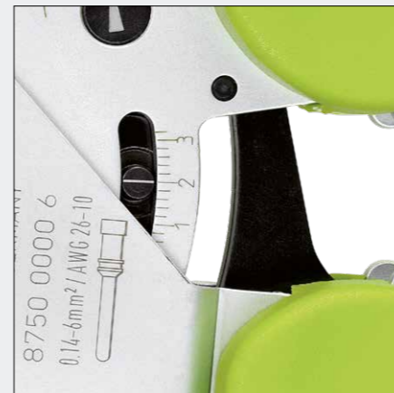
Anzeigebereich, Zwangsvollendung des Crimpvorganges
