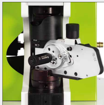
Crimpeinheit mit Universal-Kontaktaufnahme für Industriekontakte
