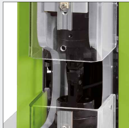
Modell CM 25-1 – Crimpmaschine für universellen Einsatz mit Schutzvorrichtung
