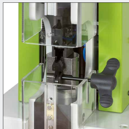
Crimpmaschine CM 25-2 zum Verarbeiten geschirmter Steckverbinder
