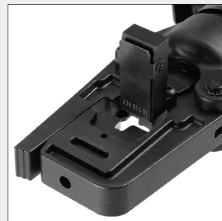
Kontaktaufnahmen für spezielle Crimpeinsätze verfügbar
