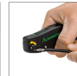
Abisolieren von 3 Lagen in einem Arbeitsgang
