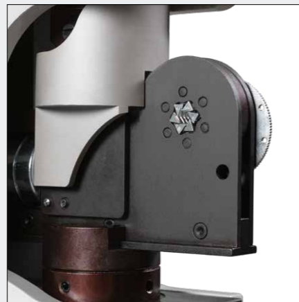
selbsteinstellende Crimpeinheit, 6 profilierte Crimpflächen, Art. Nr. 636 086 3
