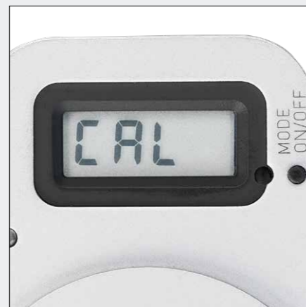
elektronische Verschleißüberwachung (patentiert) mit Warnfunktion
