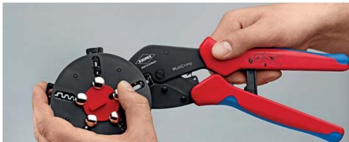
Sostituzione matrice di crimpaggio: sbloccare il fermo della matrice sul supporto e successivamente rimuovere la matrice
