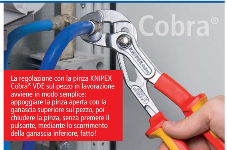
La regolazione con la pinza KNIPEX Cobra® VDE sul pezzo in lavorazione avviene in modo semplice: appoggiare la pinza aperta con la ganascia superiore sul pezzo, poi chiudere la pinza, senza premere il pulsante, mediante lo scorrimento della ganascia inferiore, fatto!
