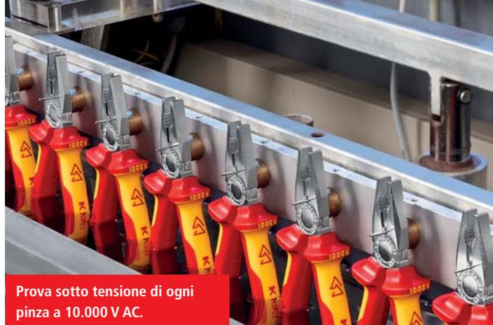
Prova sotto tensione di ogni pinza a 10.000 V AC.
