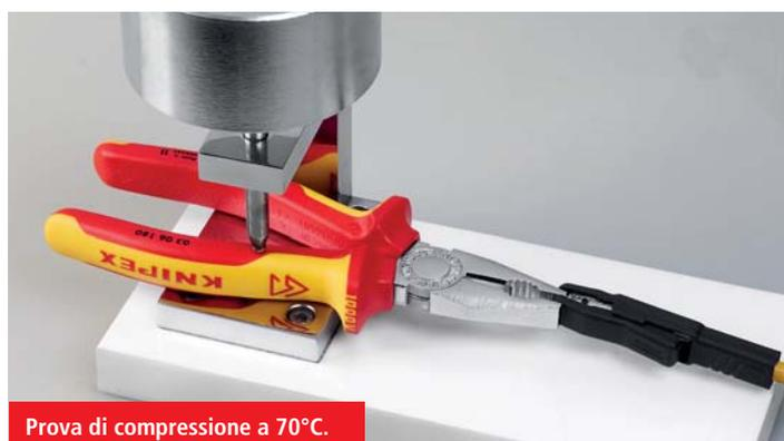
Prova di compressione a 70°C.
