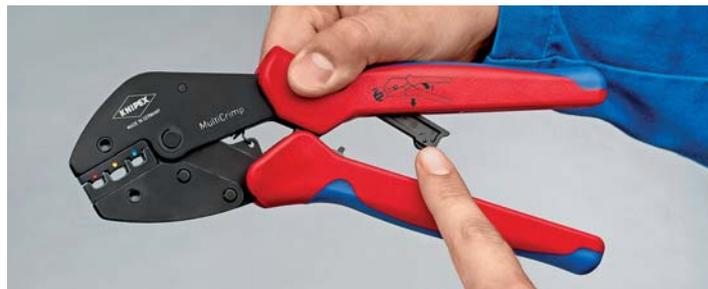
Sbloccare la leva di posizionamento e chiudere la pinza - pronta per l'uso
