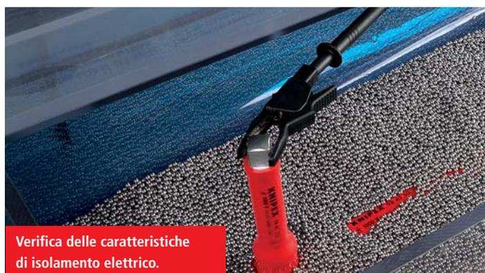
Verifica delle caratteristiche di isolamento elettrico.
