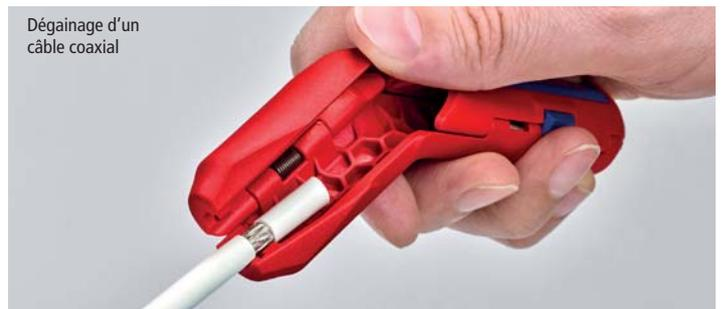
Dénudage d'un câble coaxial
