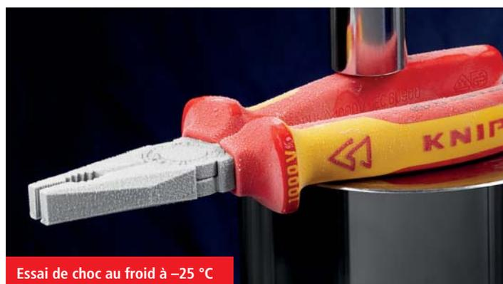
Essai de choc au froid à -25 °C
