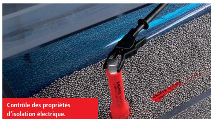
Contrôle des propriétés d'isolation électrique.
