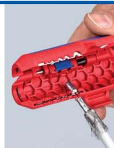
Dénudage d'un câble coaxial
