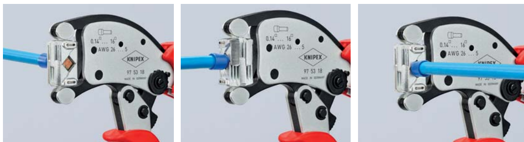
Einmalig flexibel: Verbinder können aus nahezu jeder Position in den drehbaren Crimpkopf eingeföhrt werden
