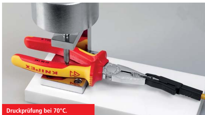
Prüfung der Haftfähigkeit der VDE-Hüllen mit 500 N bei 70°C.
