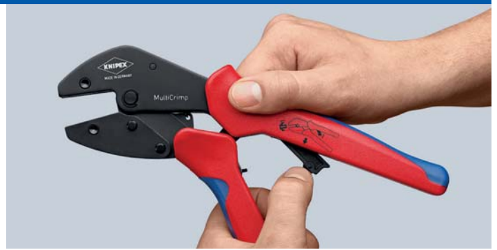
Wechselposition: Ausklappen des Service-Hebels für parallele Backenstellung
