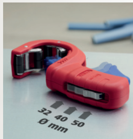
Trois diamètres avec un seul outil : le diamètre du tube peut être préréglé à l'aide du dispositif de réglage en métal.
