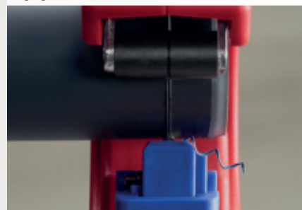
Des segments de seulement 10 mm peuvent être coupés. Les copeaux en spirale proviennent du chanfreinage.
