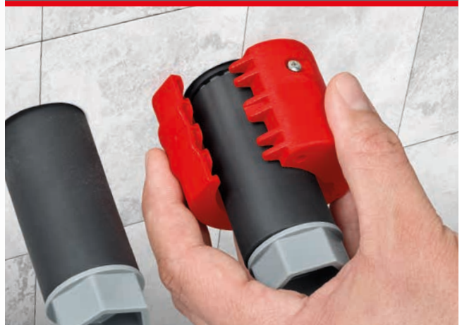
Durch die einzigartige Konstruktion des drehbaren Messerblocks lassen sich Tropf- und Dichthülsen zuverlässig 2 bis 3 mm vor der Wand einkürzen, um Feuchtigkeit sicher abzuleiten.
