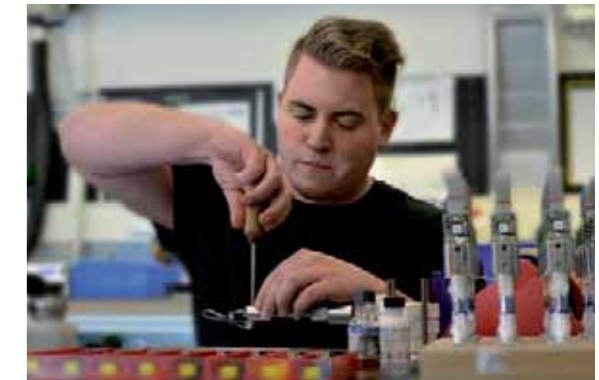
Drehmomentschlüssel von STAHLWILLE – von Hand montiert für höchste Ansprüche.
