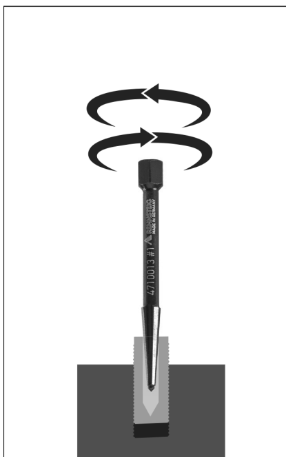
allentare e svitare la vite bloccata con un utensile adatto
