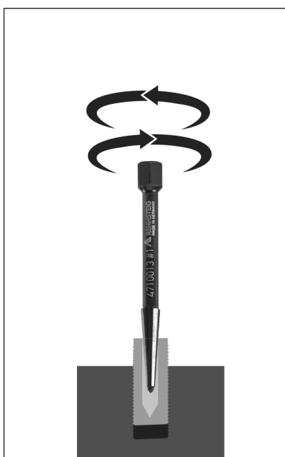
Débloquer et extraire une vis bloquée au moyen d'un outil adéquat
