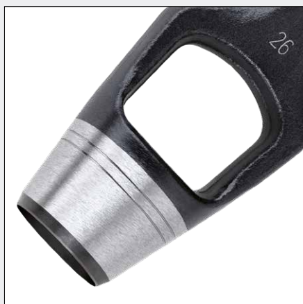
Tête de coupe conique, aiguisée et affinée, intérieur légèrement conique pour éloigner les découpes
