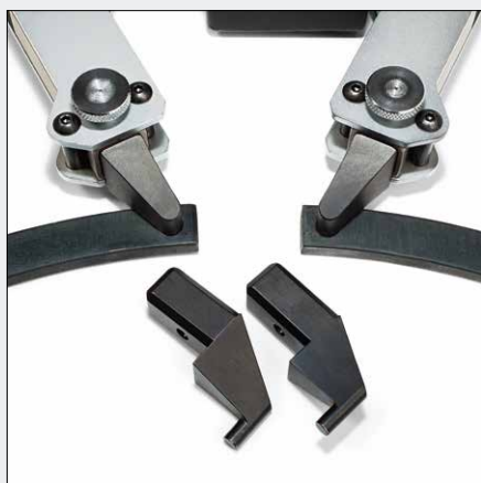
Wechselbare Spitzenpaare für Innen- und Außenringe
