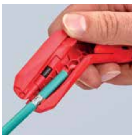
Sguainatura di un cavo per trasmissione dati
