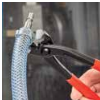
Ermetizzazione di tubo pneumatico su giunto rapido con basetta anteriore di compressione
