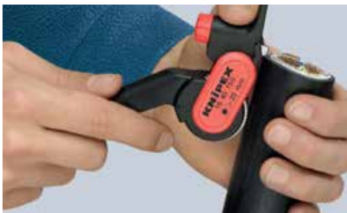
Posizionamento dell'utensile per taglio longitudinale
