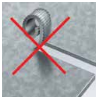
Intaglio senza rottura del truciolo
