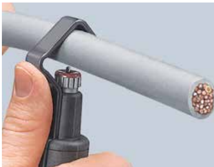
Posizionamento dell'utensile per taglio perimetrale
