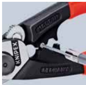
Crimpaggio del terminale sulla fune metallica
