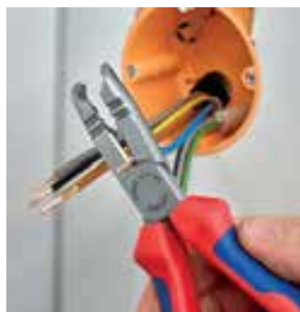
Taglia quando si accorciano conduttori singoli
