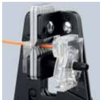
Taglio netto dell'isolamento sull'intera circonferenza
