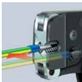
97 53 08: Introduzione laterale di terminali a bussola fino a 2,5 mm 2 , p. es. in spazi ristretti
