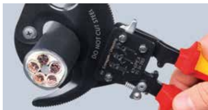
Sistema a cricchetto e avanzamento della lama regolabile in due posizioni per un taglio con sforzo minimo
