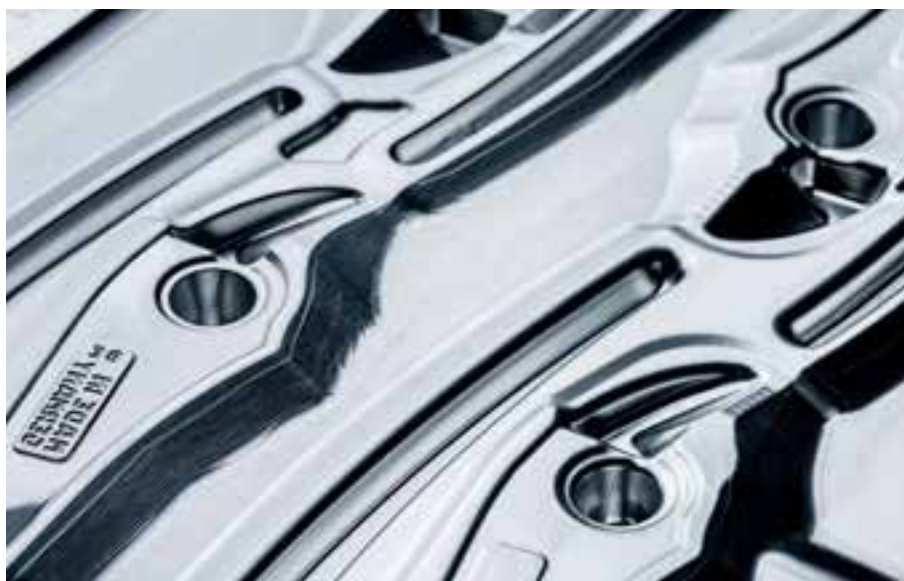
Stampo di forgiatura per tronchese laterale «forte» con articolazione forgiata.
