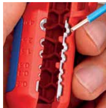
Spelatura isolamento di singoli conduttori
