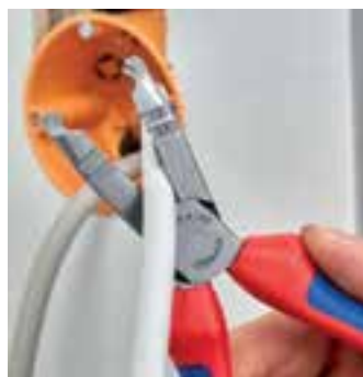
Taglio di cavi fino a Ø 13 mm
