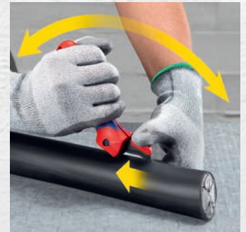
Durch Ratschenfunktion mit mehr Komfort und weniger Kraftaufwand abmanteln
